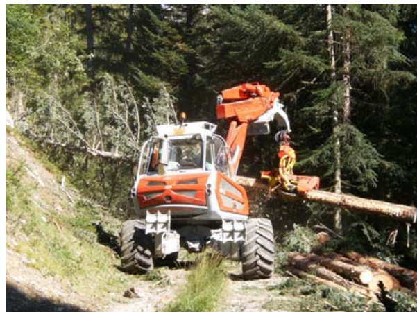
Rationelle Nutzung durch modernen Maschineneinsatz (Schreitbagger mit Vollerteragrat „Woody 50“)
